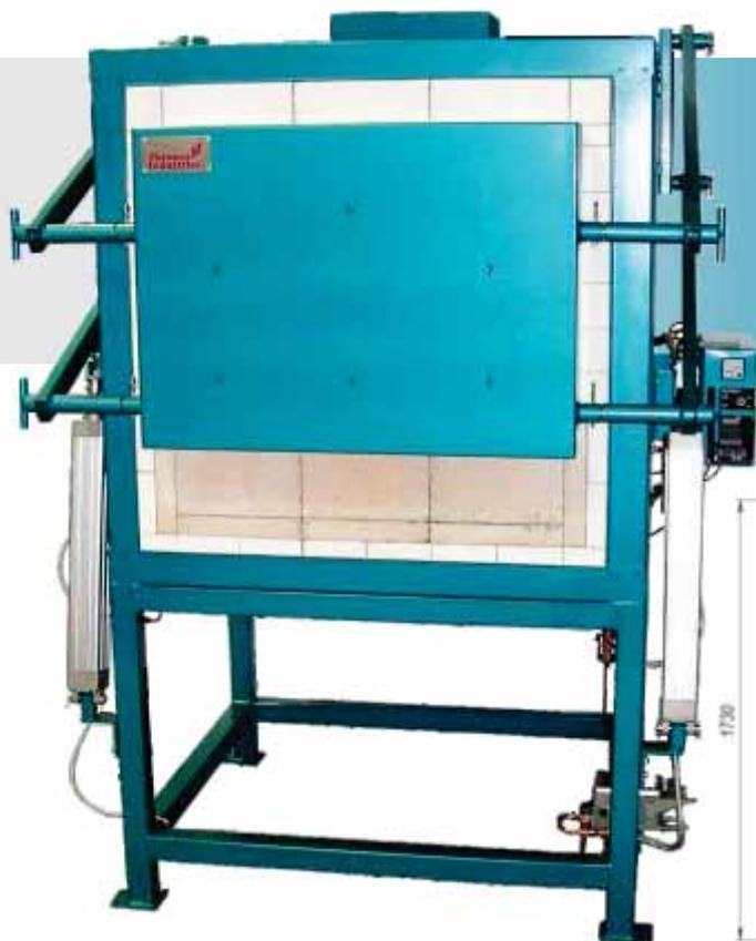
Корпус выполнен из листовой стали толщиной 5 мм, станина из прямоугольного профиля замкнутого сечения 64x64x2,6 мм. Высокостойкое лакокрасочное покрытие синего цвета Хаммерфин. Футеровка 70% глиноземный огнеупорный кирпич.
