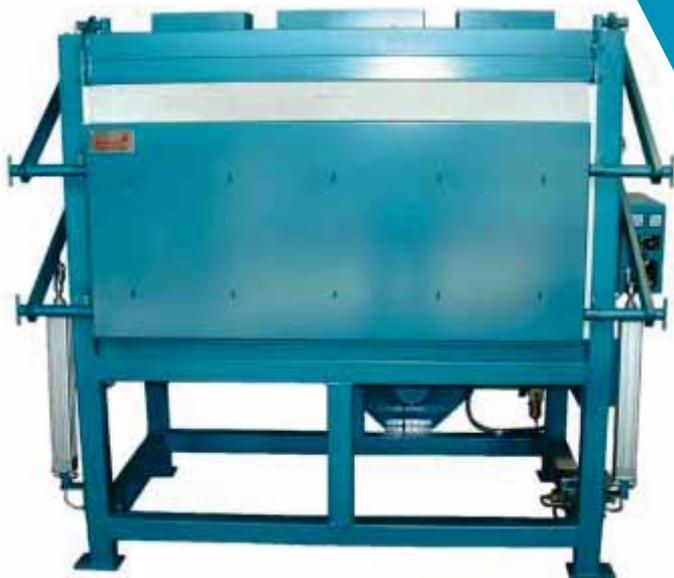
Корпус выполнен из листовой стали толщиной 5 мм, станина из прямоугольного профиля замкнутого сечения 64x64x2,6 мм. Высококачественное лакокрасочное покрытие синего цвета Хаммерфин. Футеровка 70% глиноземный огнеупорный кирпич.
