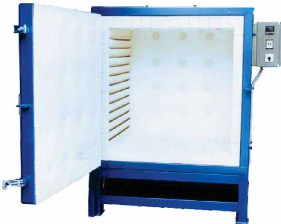
Корпус выполнен из нержавеющей стали марки 304 толщиной 2 мм, станина из прямоугольного профиля замкнутого сечения 51x51x2,6 мм. Футеровка огнеупорными кирпичами с изоляционным шитом из вермикулита на тыльной стороне. Высококачественное лакокрасочное покрытие синего цвета Хаммерфин.
